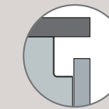
Gola scavata Hollow groove
